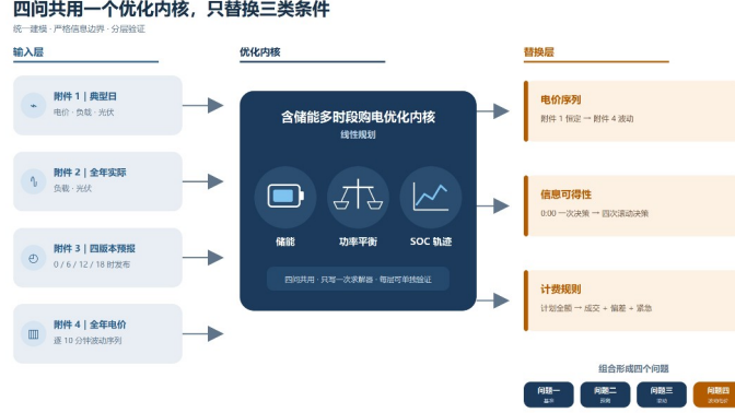
图 7 四个问题共用的购电优化内核及三类替换条件
